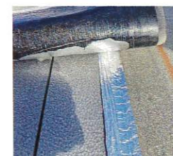
Detektions-Abdichtungsbahn: Büsscher & Hoffmann bietet eine Elastomerbitumen-Kaltselbstklebebahn mit integrierter „e-plax“-Technologie zur Dichtheitsprüfung mittels Funken-schlagverfahren oder Elektroimpulsverfahren. Fotos: Büsscher & Hoffmann
